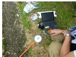
データロガーを使って水の濁度を測定しています。温度、湿度、pH など 13 項目を測定できます。PC に接続してグラフなどを表示させることもできます。
