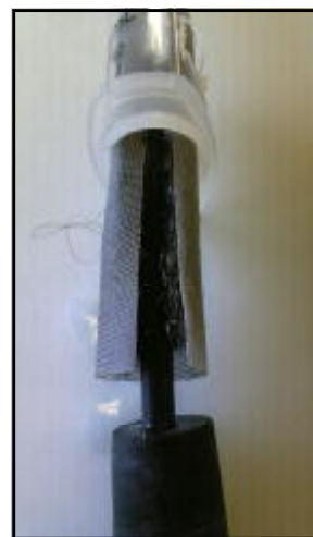
写真15 スチールワール等でコーティングした電極
