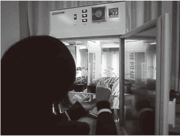
図6 赤・青の光にわけられた人工気象器内の様子
