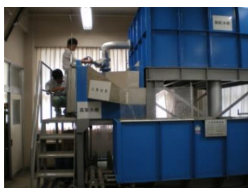
水の流れを調べる水理実験
