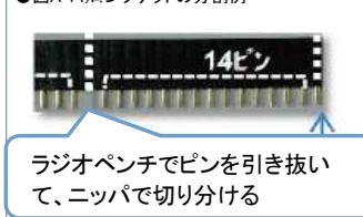
●図C 各ICのピンの処理
