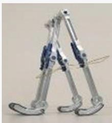
私達は何気なく足を出して 2 足歩行をしています。スムーズな足の動きはロボットで動かすととても大変で「歩くこと」が複雑な仕組みであることを教えてくれます。受動歩行ロボットは、電気などのエネルギーを使わず、重力のみによって緩やかな
