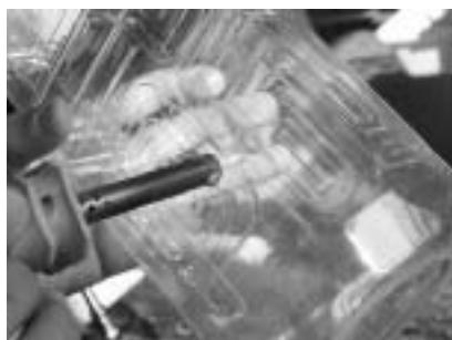
② 穴に針金を通し、脱落を防ぐために先端を曲げ、セロテープで固定する。
