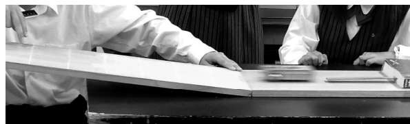
図7 偶数班の実験 (押し込まれた距離 l と高さ h の関係を調べる)
