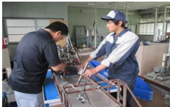
図5 エンジン搭載後ワイヤー調整
