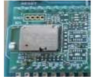
図 2 太陽誘電社製の BLE モジュール
