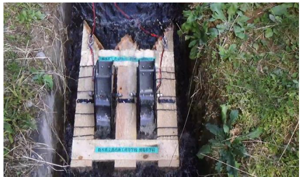
用水路での発電試験
