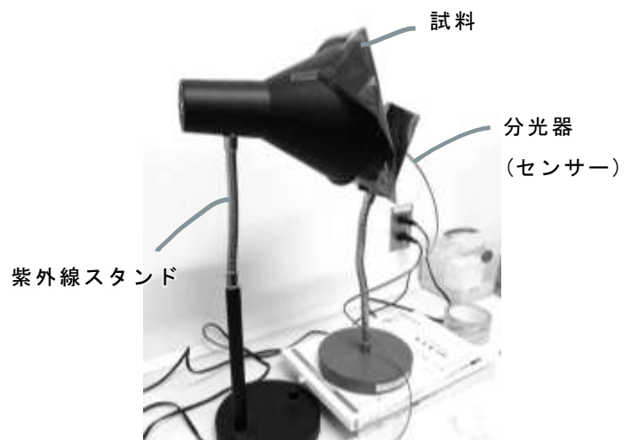
図6 実験の様子 (試料に紫外線を照射)
