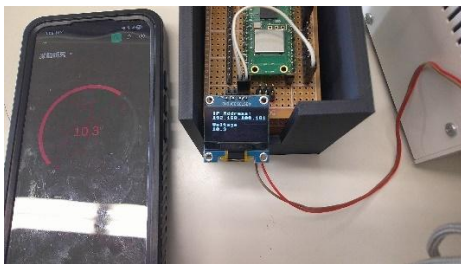
図4 Wi-Fi 通信で電圧をスマートフォンで表示
