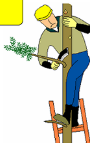
鉋（なた） 細い木を切ったり、枝を切り落とすとき （枝打ち）に使います。 山で働く人には必需品です。
