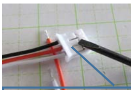
精密ドライバで爪をあげ、赤黒線ははずして、入替える
