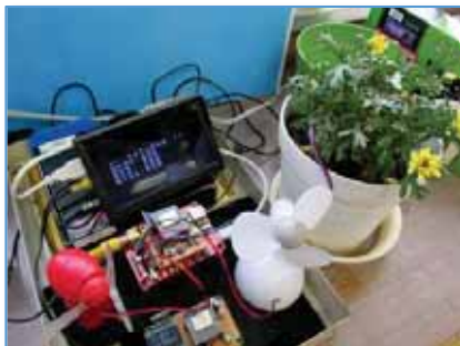
写真6 試作したIoT装置 気温・湿度・土壌水分などを測定、そのデータをクラウドサーバにアップする実験
