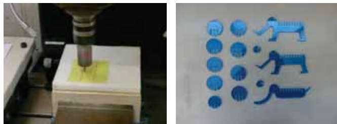
図3. NC で切削した部品
