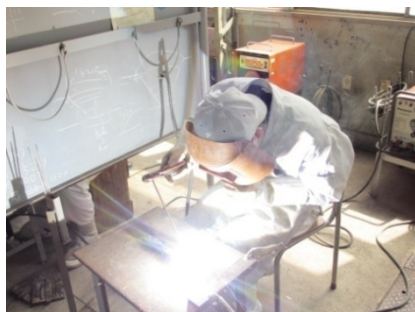
アーク溶接実習
