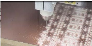
図 4 IC ソケット基板の製作
