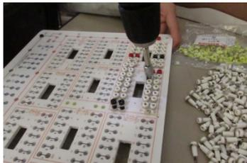
電動ドリルを使い、色分けをしながらピンジャックを取り付けていきました。(赤:電源・黒:GND・青:入力・緑:出力・白:データ)
