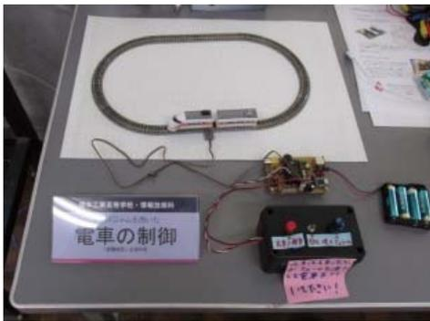
栃工版 IchigoJam を使った模型電車を製作、コントロールBOXなども作成し、一般の方でも体
