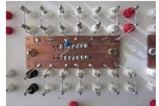
図 6 コンデンサの取り付け
