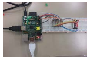
図3 7セグメントLEDの点灯
