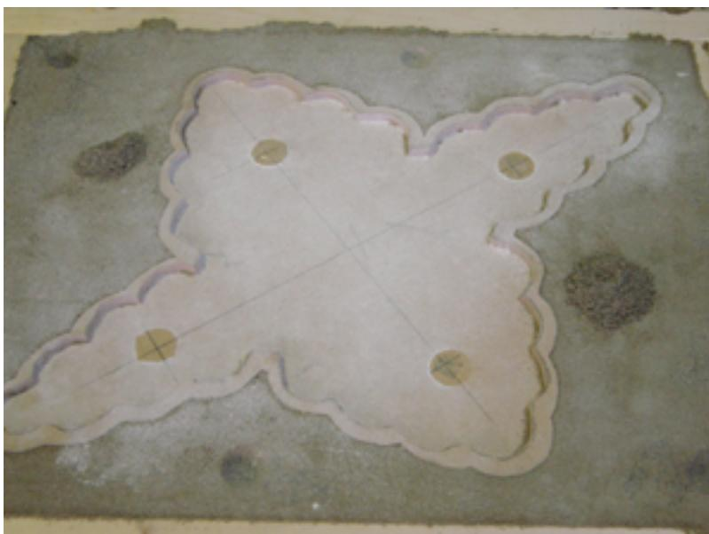
炭酸ガスをかけると硬化する「ガス砂」という砂を使いました。炭酸ガスを注入しているところです。
