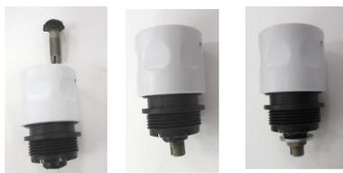
・散水コネクタを加工した部品にチューブの口金を挿入します。ワッシャーを入れナットで固定します。ラジオペンチを使って締めてください。
