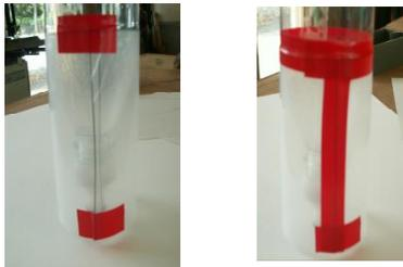
ペットボトルを噴射口を下にしてスカートを取り付けます。始上の部分と下の部分を仮止めし、ペットボトルにぴったり合うように仮止めしてください。上の部分と下の部分直径が同じになるようにし、継ぎ目をビニールテープでとめてください。また、ペットボトルとスカートもビニールテープを使ってとめてください。
