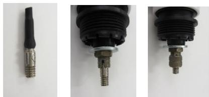
・バルブ、虫ゴム、トップナットを組込発射口の完成です。
