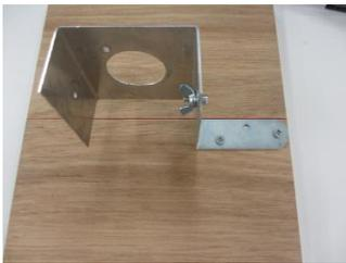
・コの字形の金具を先ほどのL字金具に取り付けます。取り付けには小ねじと蝶ナット固定します。小ねじはプラスドライバーを使い、蝶ナットは手でしっかり握って締めて下さい。
