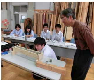
たわみ量測定の様子
